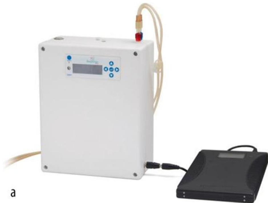
FIGUUR 1 (a,b) Prototype van een 'wearable artificial kidney' die ontwikkeld is binnen het Nephron+-samenwerkingsverband. Het apparaat is ongeveer 24 cm hoog. Foto's: Nanodialysis BV.
